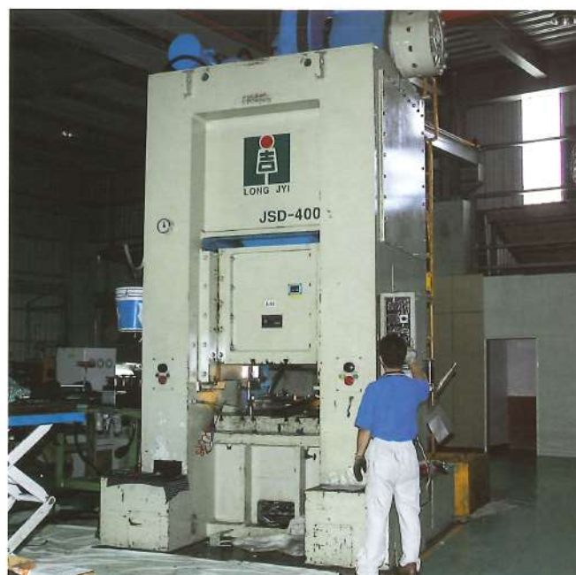
400T hydraulic press / 400T 沖床設備
